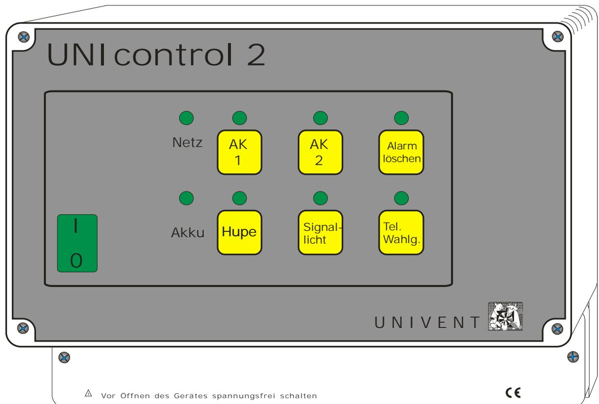
Mit dem Schalter können Sie das gerät EIN – AUS schalten! Im ausgeschalteten Zustand wird der Akku nicht geladen!
